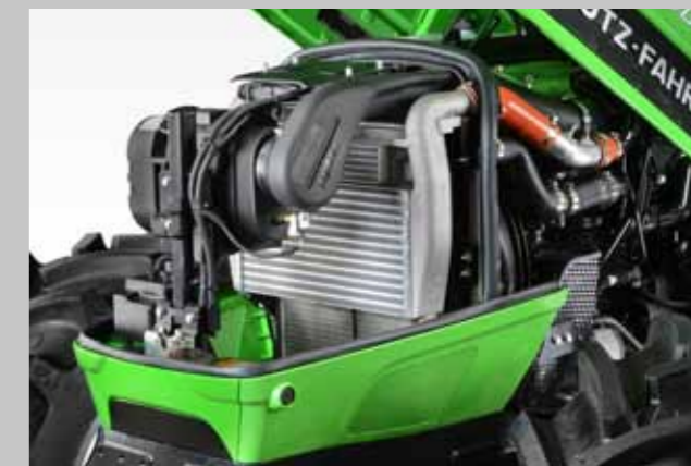
Kompaktowy pakiet chłodnic, filtr PowerCore.
